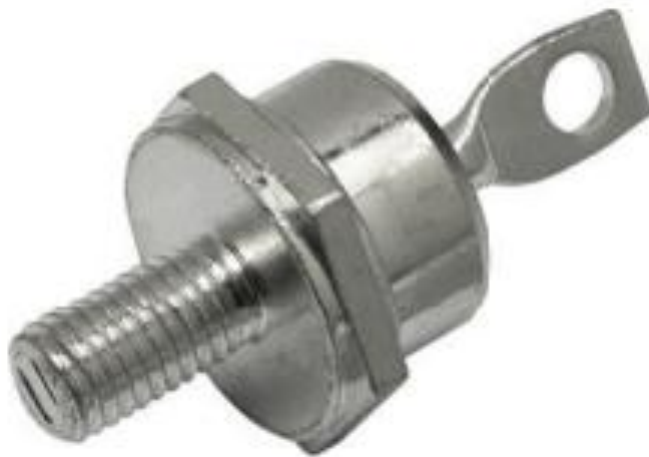
Εικόνα Α.15 :Μοντέλο διόδου VS-70HF(R) με voltage code 20 της εταιρίας Vishay
